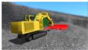
Задание №5. Нижняя погрузка грунта в кузов обратной лопатой через задний борт
