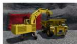
Задание №8. Погрузка грунта в кузов обратной лопатой через боковой борт на одном уровне стояния
