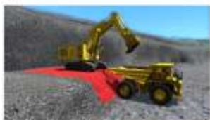
Задание №5. Нижняя погрузка грунта в кузов обратной лопатой через задний борт
